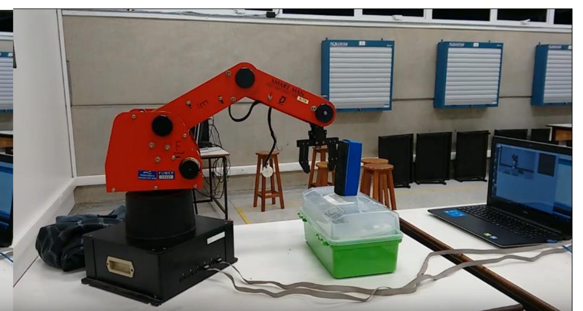
Figura 1: Deslocamento feito pelo robô do ponto inicial (A) até o objeto (apagador de lousa azul) que é ponto final (B) através da identificação de cores pelo Processing (software) utilizando a câmera.
