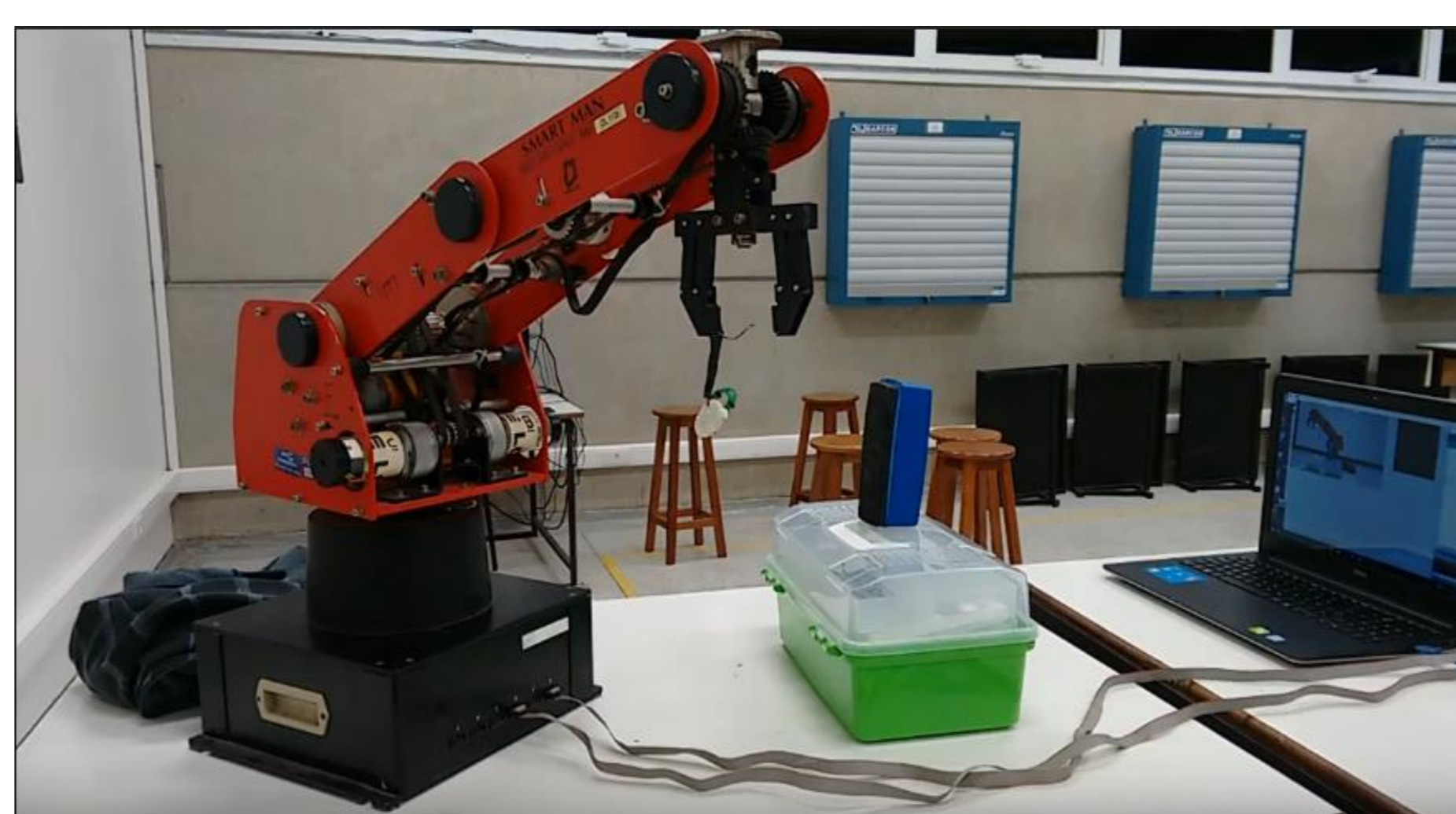
Figura 1: Deslocamento feito pelo robô do ponto inicial (A) até o objeto (apagador de lousa azul) que é ponto final (B) através da identificação de cores pelo Processing (software) utilizando a câmera.
