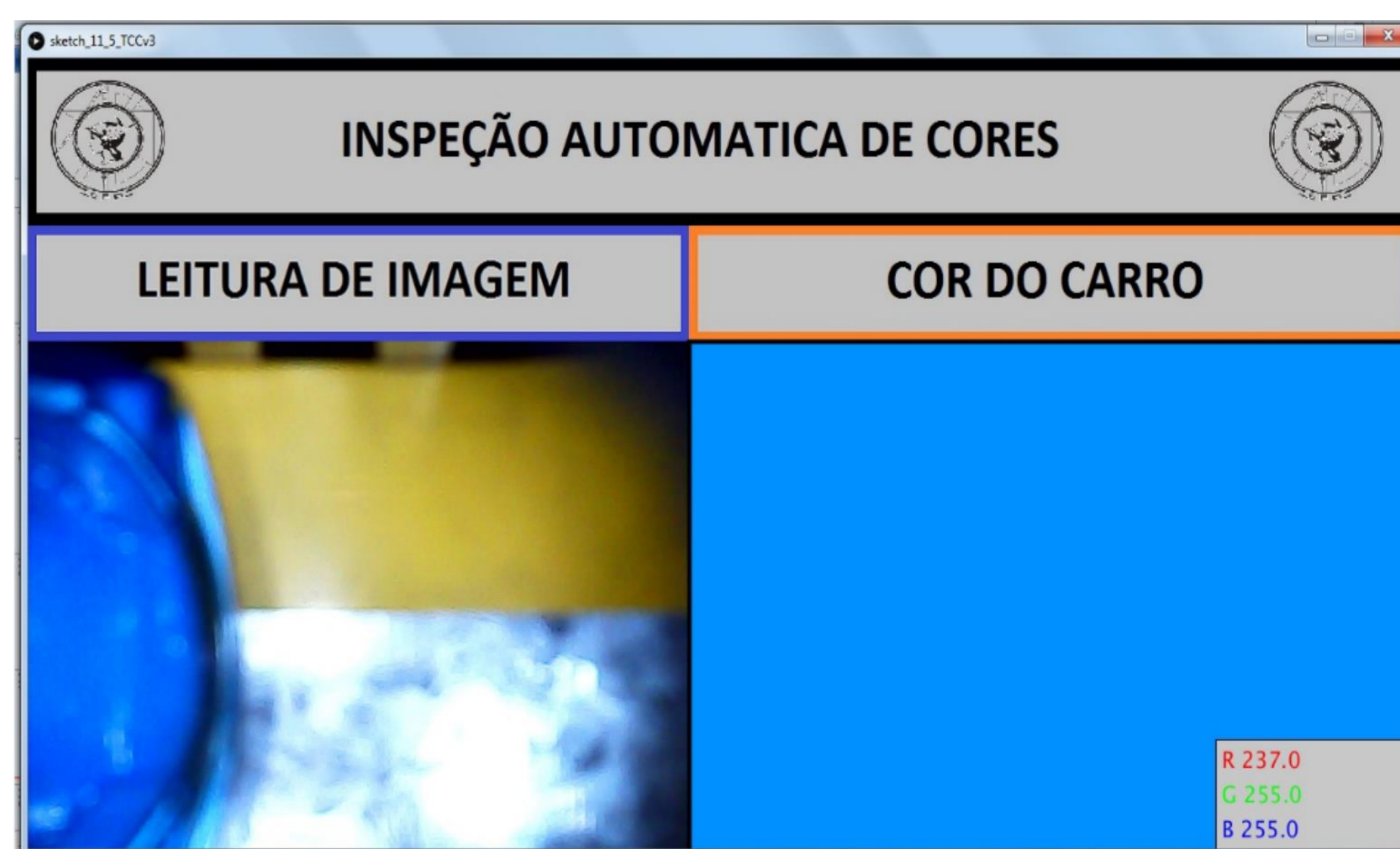
Fig. 2: Exemplo de inspeção de cor automatizada através da leitura de imagem da amostra (LEITURA DE IMAGEM) e retorno da informação captada como (COR DO CARRO)
